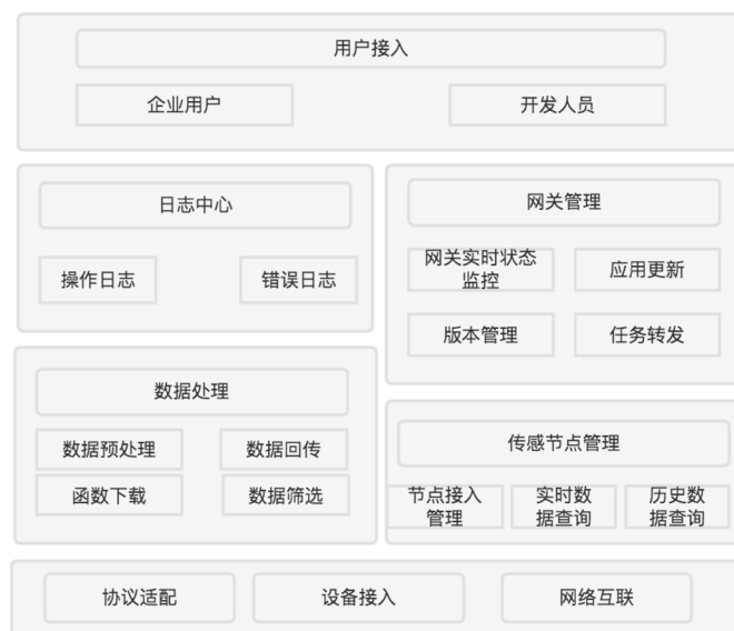
图 4: 工业互联网网关管理平台功能结构图
