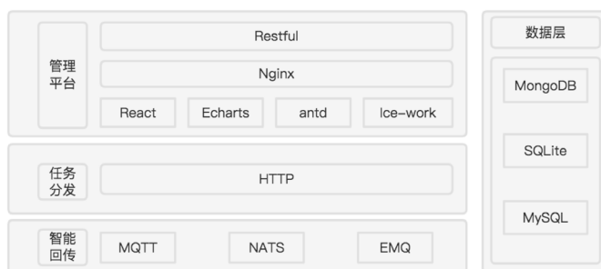
图 3: 工业互联网网关管理系统架构图
