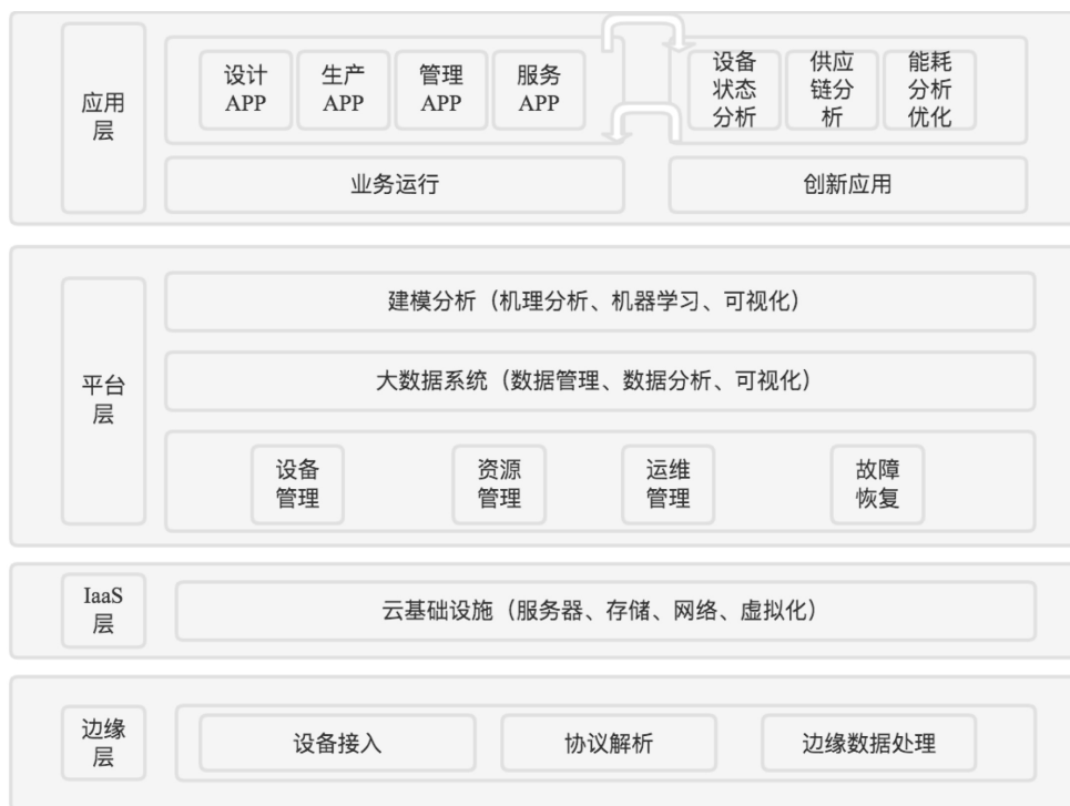
图 1: 工业互联网通用平台架构
